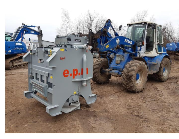
Der Aushub wird mithilfe von Mischbindemittel aufbereitet und wieder eingebaut um die Tragfähigkeit zu erzielen
